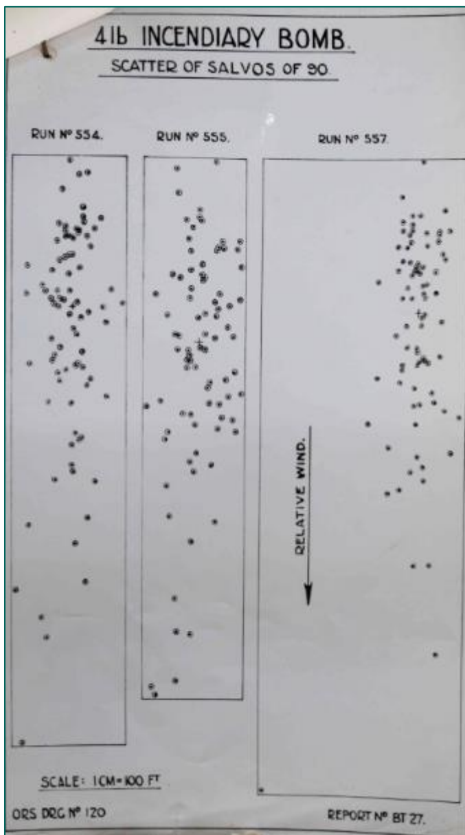
Figuur 81: 4 lb. bomb trial. (Bron: TNA, AIR2/7537).
