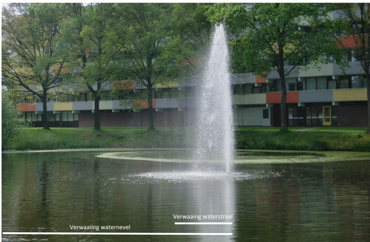
Figuur 4-1 Het effect van wind op de waterstraal en waternevel van een fontein
