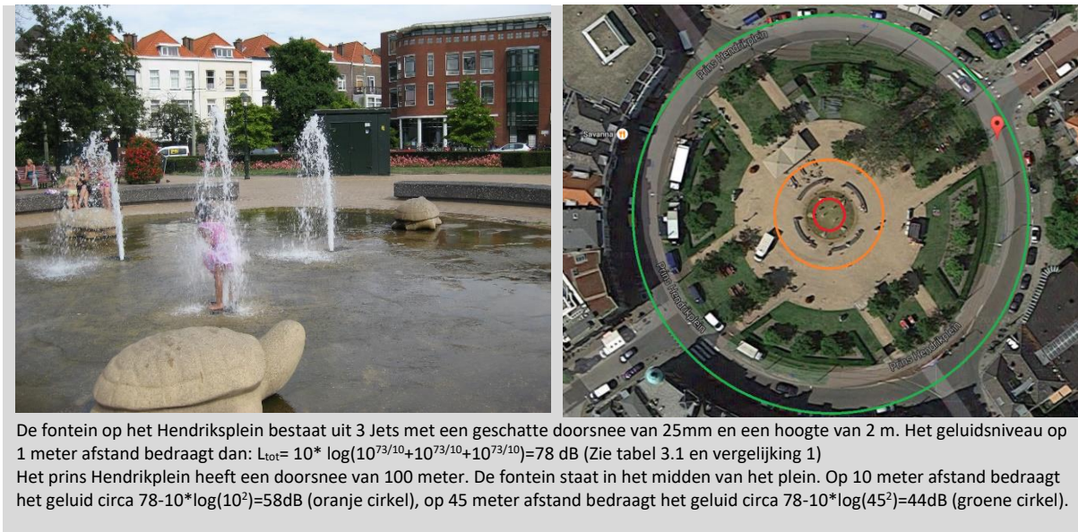
Figuur 3-4 Voorbeeld van een geluidsberekening op het prins Hendrikplein in Den Haag
