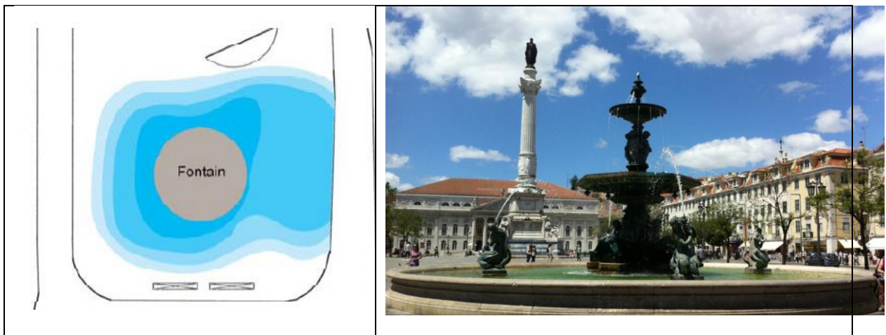
Figuur 2-4 Het verkeerslawaaai op Rossio Square in Lissabon wordt slechts deels gemaskeerd door de fontein. De blauwe markering geeft aan waar het geluid van de fontein het verkeerslawaaai maskeert.
