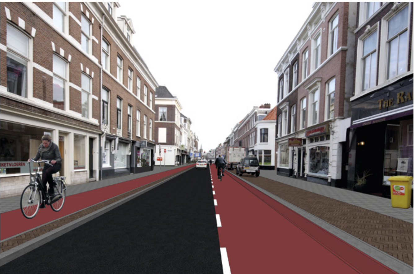
Voorbeeld van visuele versmalling door het toepassen van een ribbelstrook van 0,5 m op de Javastraat (toekomstige inrichting)
